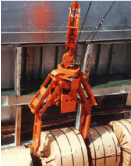
20t 縦型コイルリフター船内荷役
