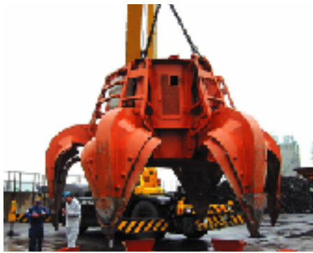
3/4㎡エンジン式オレンジピール型容積調整板付
